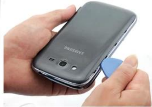
吉他拨片：起屏幕剥离外屏下面的 的双面胶
