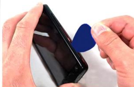
开壳拨片 起屏幕剥离外屏下面的双面胶
